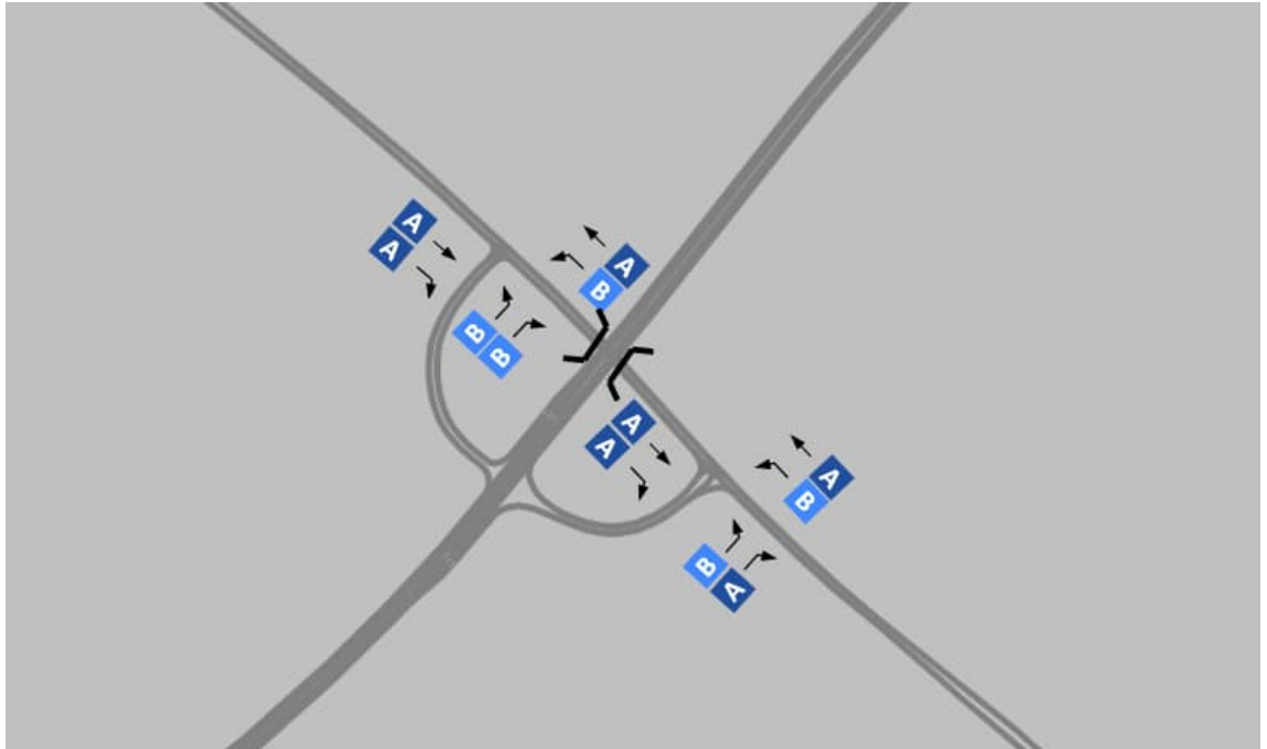
Kuva 3.9. E3 Fallbackantien eritasoliittymän liittymävaihtoehdon 1 mukaiset palvelutasoluokitukset iltahuipputunnin aikana liikenne-ennusteen VE4A mukaisilla liikennemäärillä.
