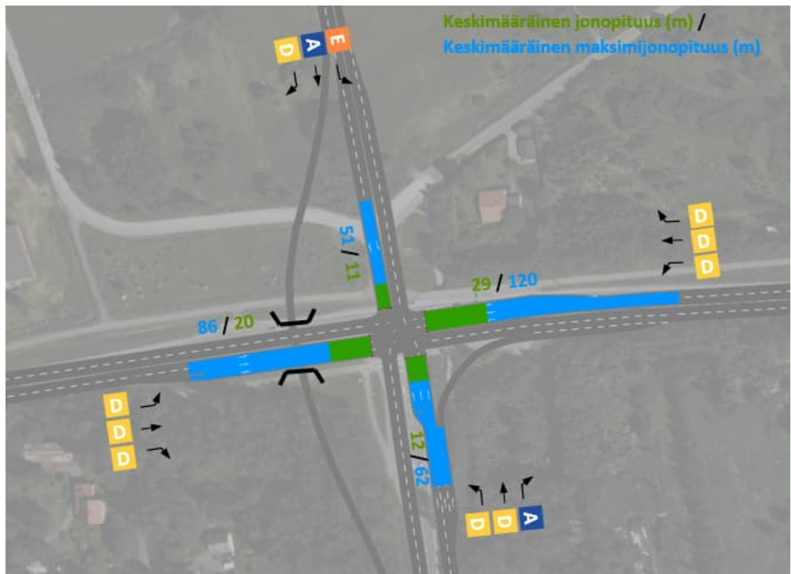
Kuva 3.17. E5 Kulloontien liittymävaihtoehdon 1D mukaiset palvelutasoluokitukset, keskimääräiset jonopituudet ja keskimääräiset maksimijonopituudet iltahuipputunnin aikana liikenne-ennusteen VE1A mukaisilla liikennemäärillä.
